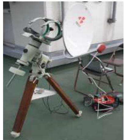
③ アンテナ面に三か所貼ったアルミホイルから反射した太陽光が放射器に集まるようにする。
