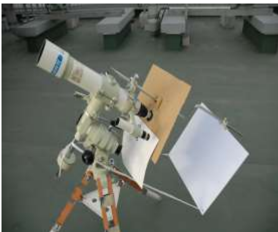
図 観測に用いた器具 影をつくる板が 42.5×32.5cm、投影板が 42×36cm
