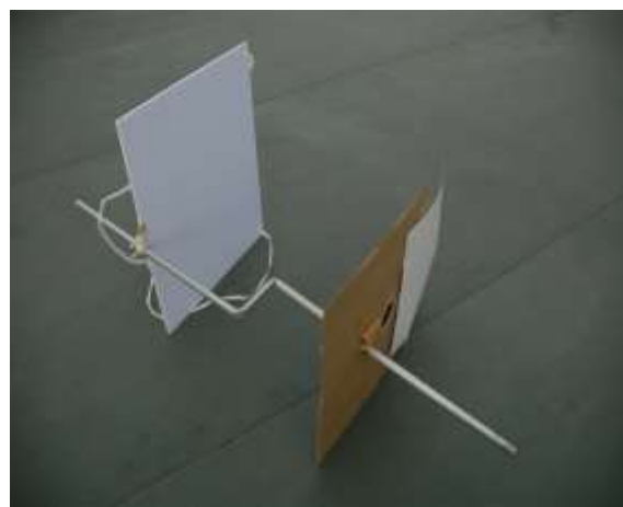
図 観測に用いた器具 影をつくる板が 42.5×32.5cm、投影板が 42×36cm
